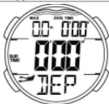
1. В режиме погружения производится измерение глубины.
